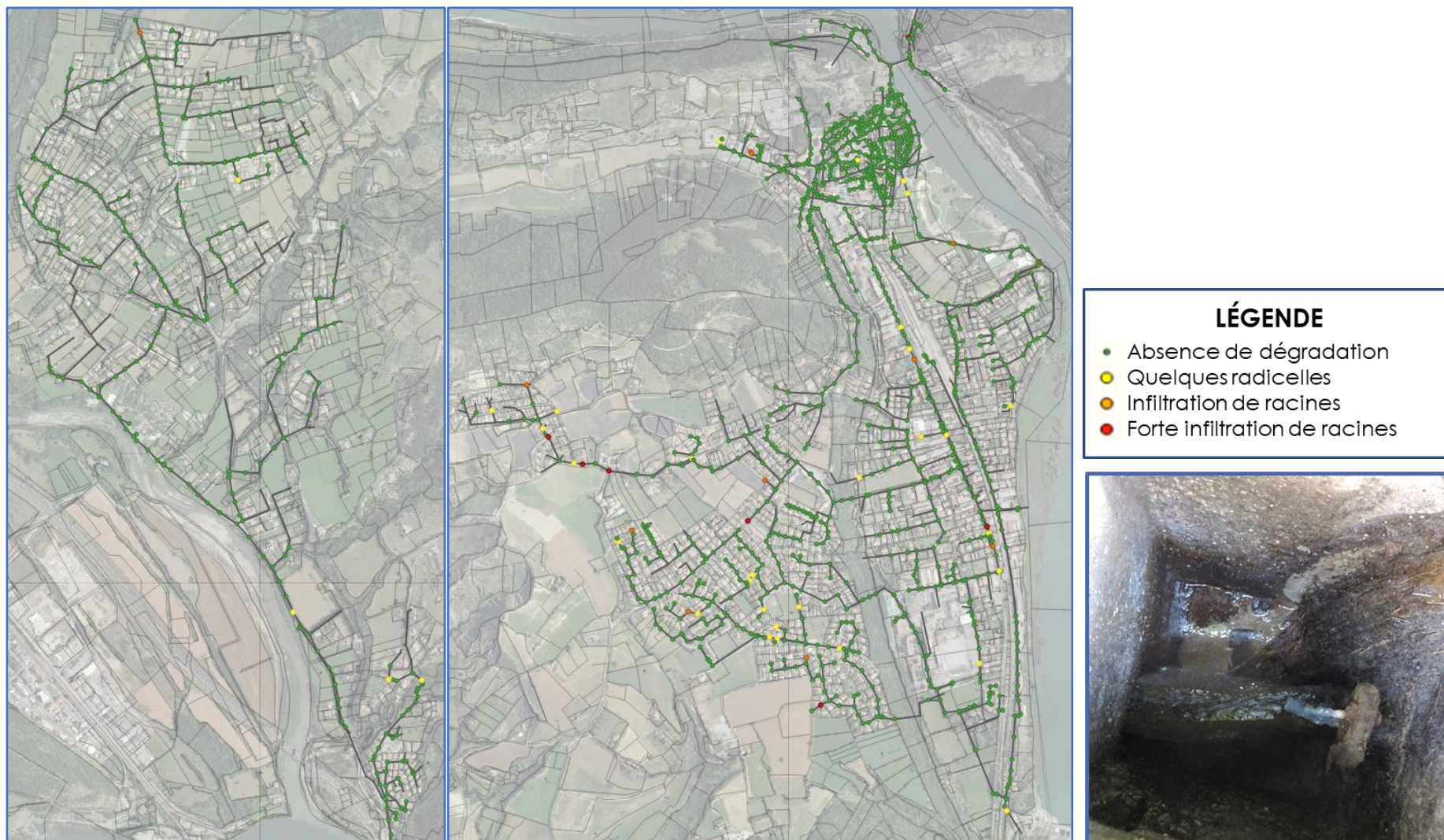
Figure 18 - Localisation des RV avec l'anomalie suivante : Infiltration de racines dans le Regard, selon gravité
