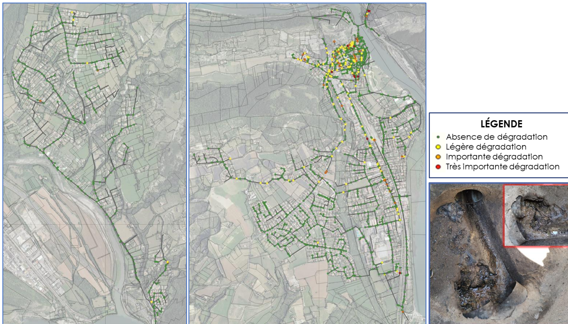
Figure 17 - Localisation des RV avec l'anomalie suivante : Génie Civil dégradé, selon gravité
