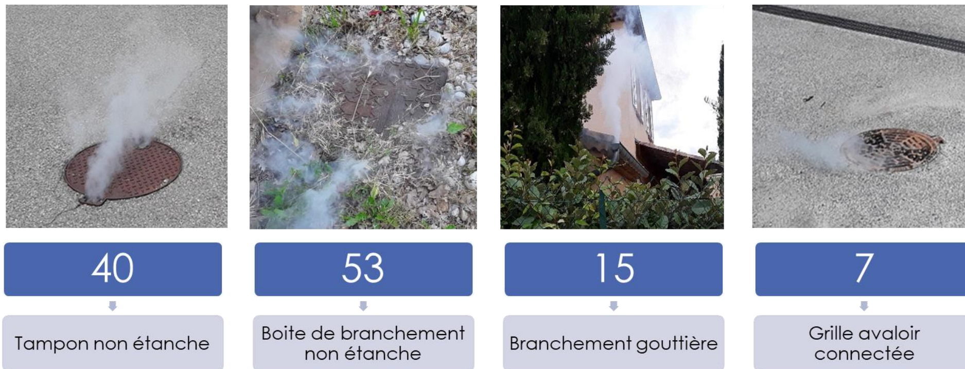
Figure 56 - Synthèse des anomalies fumée
