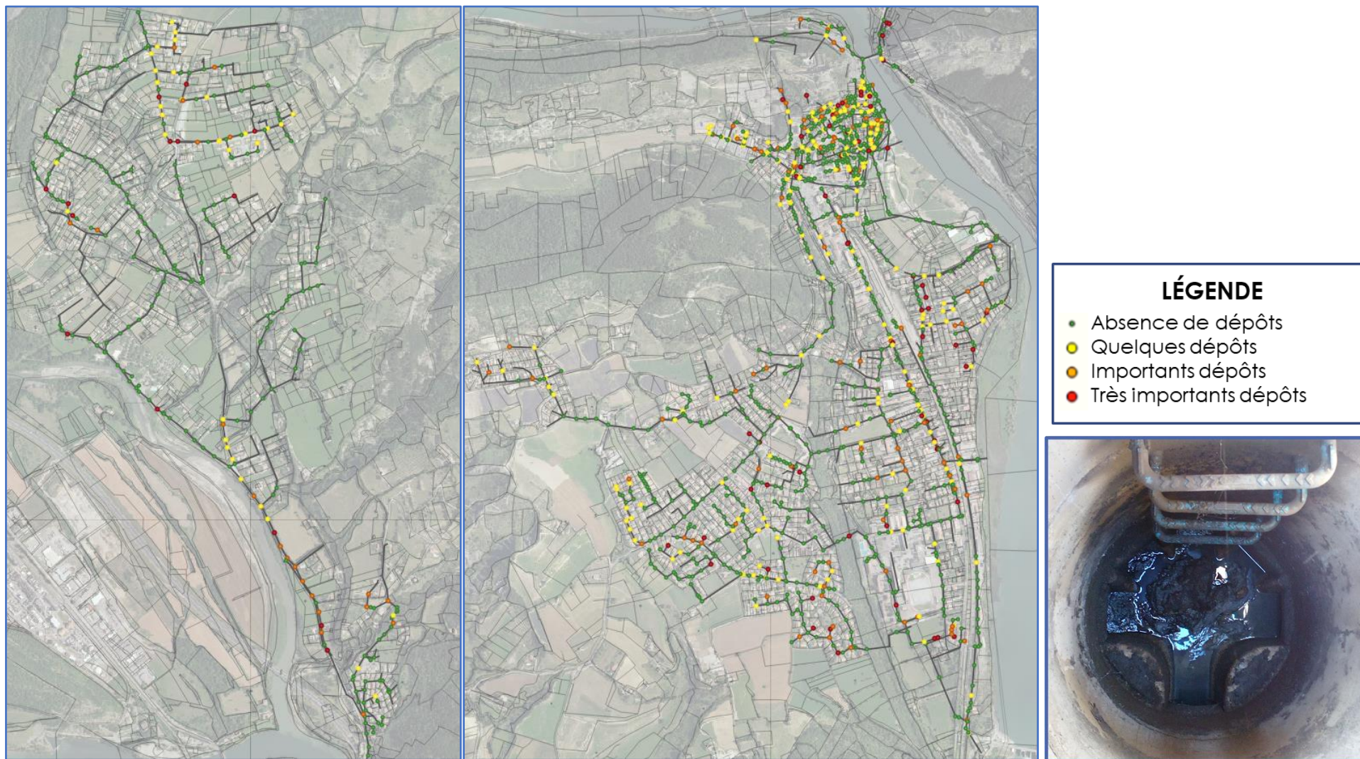
Figure 16 - Localisation des RV avec l'anomalie suivante : Dépôts dans le Regard, selon gravité
