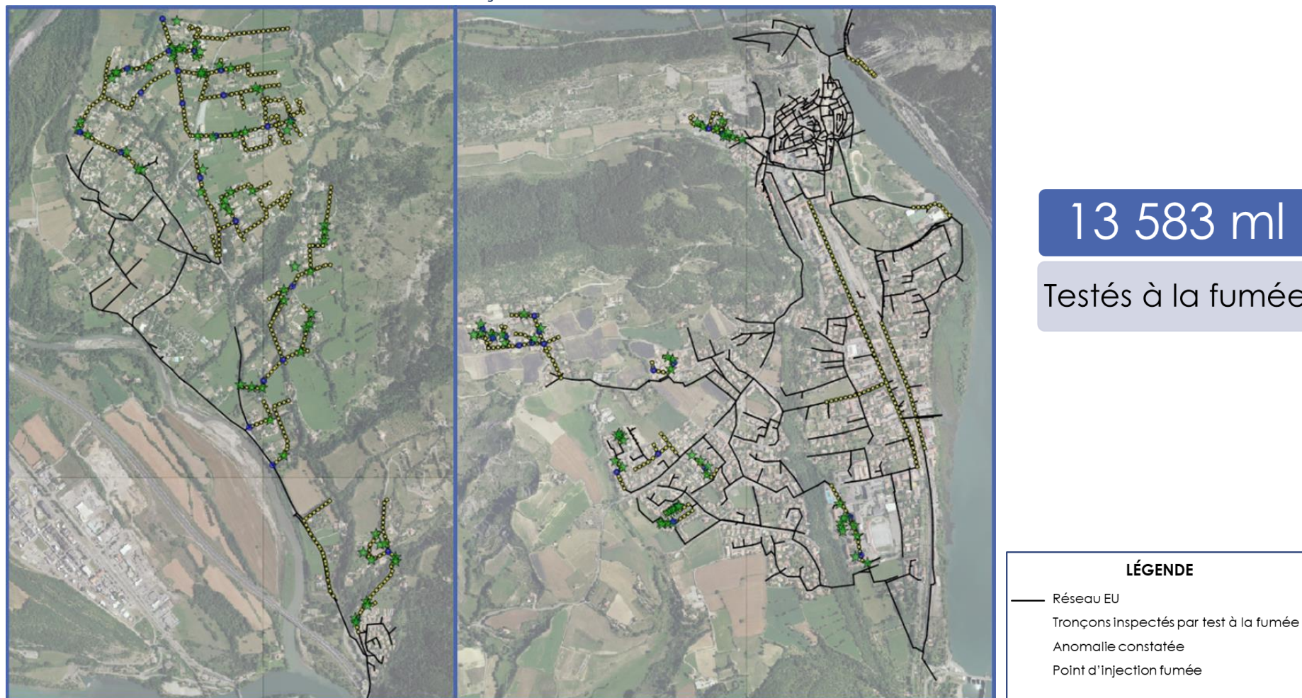
Figure 55 - Cartographie des tronçons testés à la fumée
